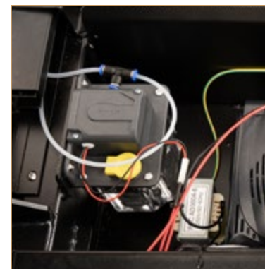
Pompa per lubrificazione automatica del piano corsa
